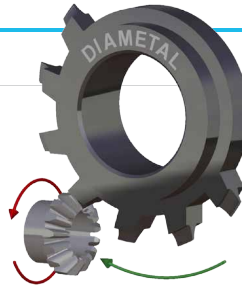
3D-Simulation für die Verzahnung eines konischen Zahnrades
