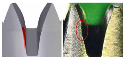
Détection d'imperfection (à gauche) retrouvée sur la pièce taillée (à droite)
